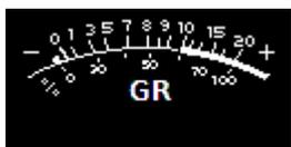
GR zeigt die Kompressionsstärke an und kann mit dem Threshold (und Ratio) Regler beeinflusst werden. Die Anzeige geht von 0 – 20 dB (0...100%). Theoretisch sind Werte bis 30 dB und mehr möglich, sind aber meist nicht sinnvoll. Je höher der angezeigte Wert, desto stärker ist die Kompression. Als Faustregel kann man festhalten, dass die angezeigte Kompression etwa dem eingestellten Wert des Threshold-Reglers entspricht. Tipps hierzu finden Sie im Kapitel „Anwendungsbeispiele“.
