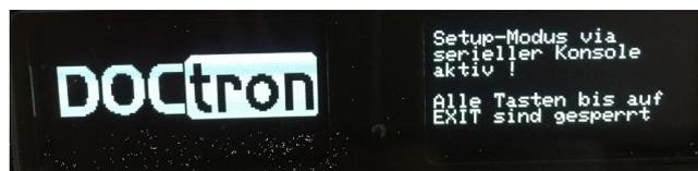
Wenn Sie die serielle Verbindung im Programmiermodus trennen, müssen Sie das Gerät aus- und einschalten, damit wieder der Normalmodus aktiv ist. Trennen Sie in diesem Fall auch bitte die USB-Verbindung kurz, um den Adapter zurück zu setzen.
