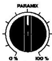
Der PARAMIX-Regler ist für die Parallel-Kompression zuständig. In Linksstellung (0%) ist PARAMIX nicht aktiv. Je weiter man nun nach rechts dreht, desto mehr unbearbeitetes Signal wird dem komprimierten Signal parallel hinzugemischt. In Rechtsstellung (100%) hat man demnach nur noch das (verdoppelte) unbearbeitete Signal. Möchte man eine Parallel-Kompression zu gleichen Anteil, ist der Regler in Mittenstellung zu bringen.
