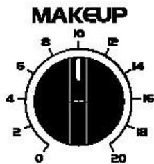
Der Make-up Regler verstärkt das komprimierte Signal von 0 bis +20 dB stufenlos.
