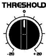
Der Threshold-Regler bestimmt den "Einstiegspunkt" des Kompressors. Der Einstiegspunkt für die Kompression kann zwischen -20 dBm und +20 dBm stufenlos eingestellt werden. Das Signal unterhalb der Schwelle passiert den Signalweg unkomprimiert.
